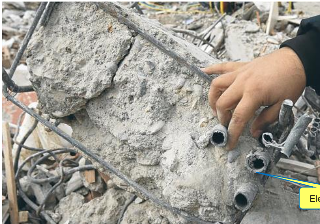
Depremde yıkılmış bir binanın kolonu: Sadece dört boyuna donatı var. Boyuna donatılar nervürsüz. Etriye bombelenme boyu çok fazla. Etriye kancası yok. Beton kalitesiz.
